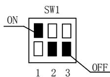
通过拨码开关，用户可以自主设定端口 C+和 C-接入的控制信号类型。
