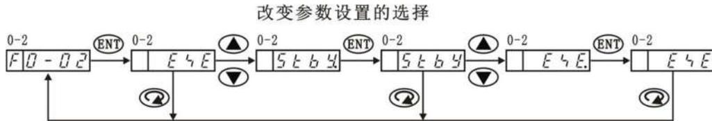
在各个窗口群中，按 键或 键可以对当前显示窗口参数值进行修改，此时值的最右一位小数点闪烁，修改完成后，按 键确认并保存修改值或按 键取消修改，此时值的最右一位小数点消隐。
