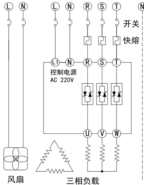
图 3-4b 负载 Y 形或△形接线方式
