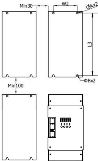
图 3-1 安装尺寸图
