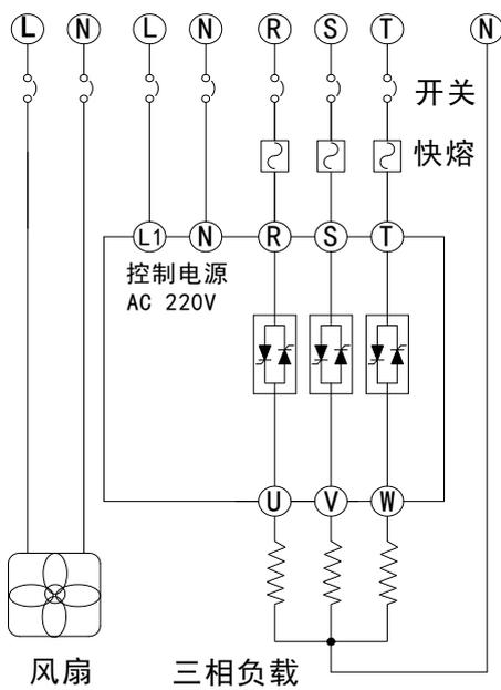
图 3-4a 负载 Y-N 形接线
