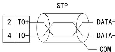
图 3-4 串口接线
